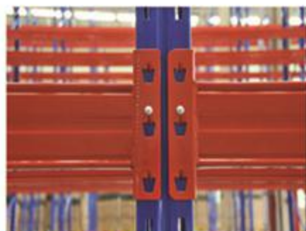
三爪柱卡 3-hooks beam
